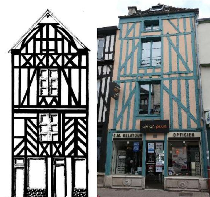
**A4.ab.29** - Le torchis sera protégé par un enduit composé de chaux aérienne **vi-vement recommandée** (CL 90 et 85) ou hydraulique (NHL 3,5 maximum) et de sable de granulométries variées. Le nu de l'enduit correspondra rigoureusement à celui des pièces de charpente. Les enduits peuvent être revêtus **d'un lait de chaux ou d'un badigeon à la chaux**. La couleur des enduits ou des badigeons est conforme au nuancier couleur en annexe.
